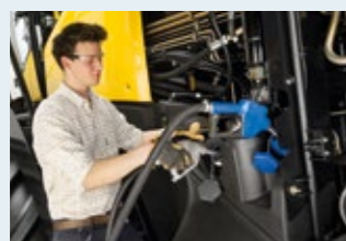
Los depósitos de combustible y de 200 litros de AdBlue están situados oportunamente uno al lado del otro para facilitar el llenado simultáneo.
