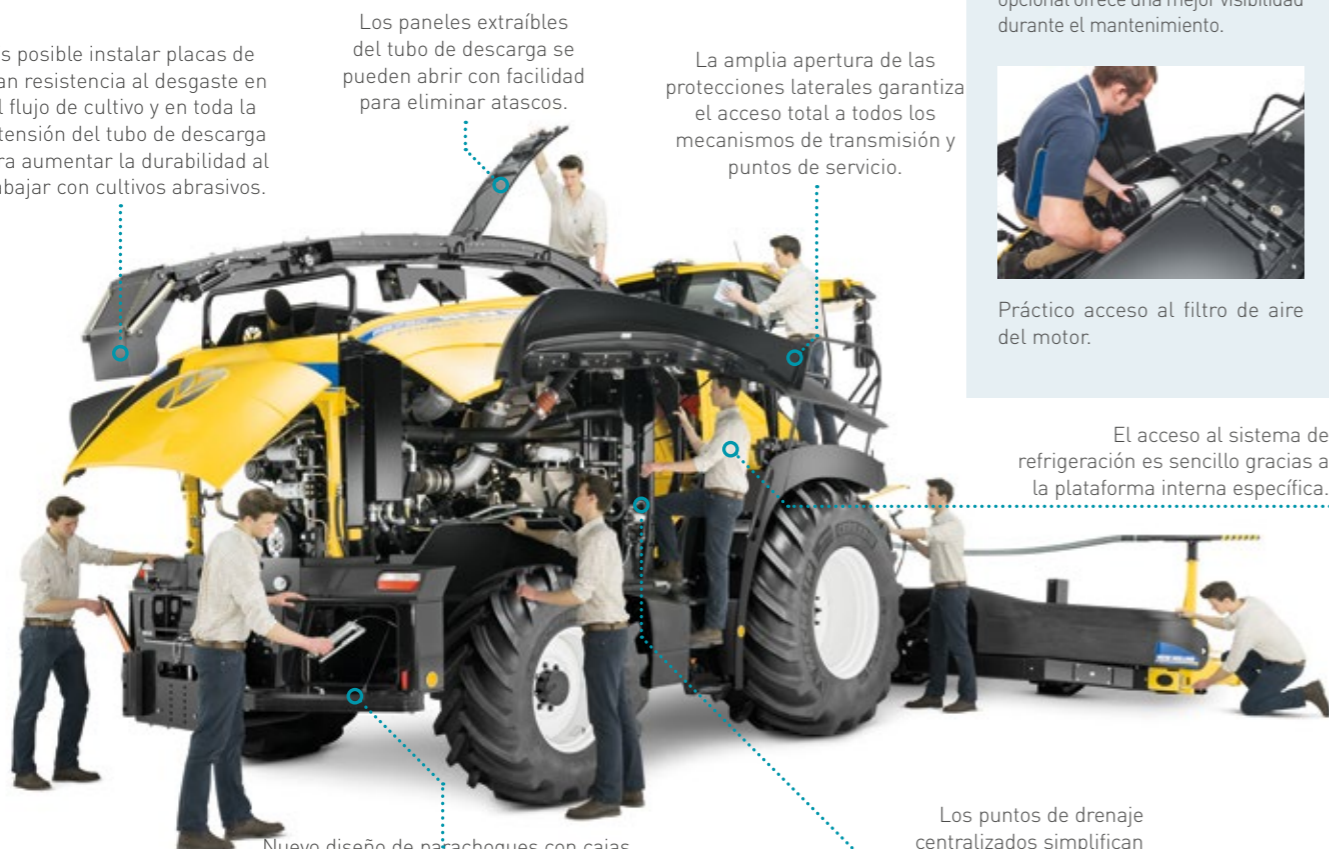
Nuevo diseño de parachoques con cajas de almacenamiento integradas y nuevos contrapesos de fácil instalación.
