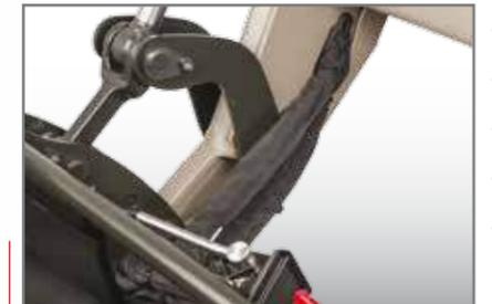
Tubos flexibles de trenza doble de 3.a función con salida del brazo protegida.
