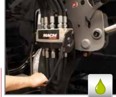
Conexión electrohidráulica tractor/pala con acoples estancos en el MACH System®.
