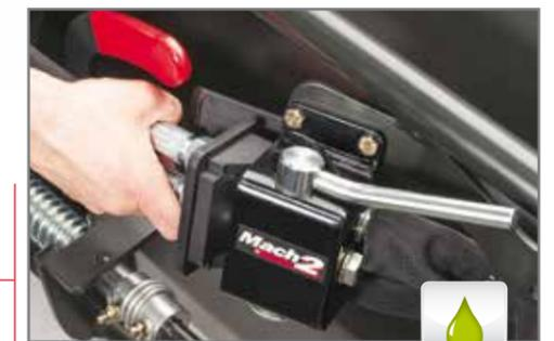
Conexión instantánea pala/implemento con acoples estancos y toma MACH 2 System®.
