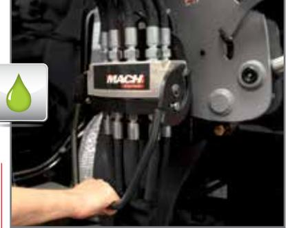
Conexión electrohidráulica tractor / pala con acoples estancos en el MACH System®.
