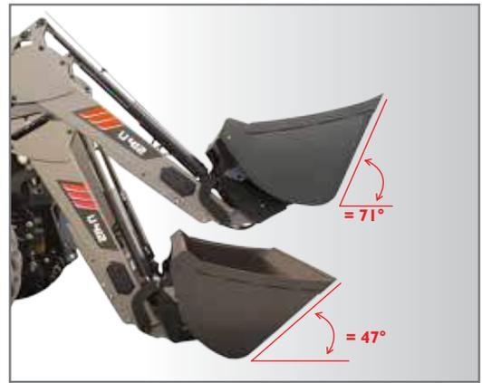
El ángulo de carga proporciona un rendimiento máximo: hasta 71° a 1,20 m del suelo.
